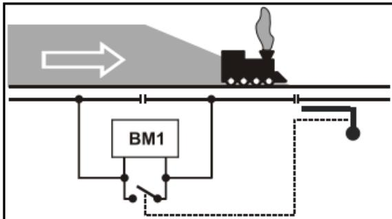
Technisch realisiert wird dies dadurch, dass der BM1 bei "rot" zeigendem Signal innerhalb des Bremsabschnittes eine Asymmetrie der ansonsten symmetrischen Digitalspannung am Gleis erzeugt. Dies detektieren die Decoder. Das Ergebnis ist ein sanftes Abbremsen des Zuges bis zum Stillstand, wahlweise mit der Bremsverzögerung oder dem eingestellten konstanten Bremsweg.
