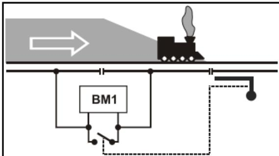
Techniquement parlant, en cas de signal "rouge", le BM1 génère une asymétrie dans la tension digitale (normalement symétrique) qui est appliquée aux rails de la section de freinage. Les décodeurs de la série GOLD détectent ce changement avec pour conséquence un freinage doux du train jusqu'à l'arrêt complet, au choix selon la temporisation de freinage encodée ou selon la distance de freinage constante encodée.
