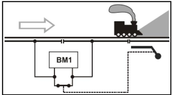
Soll der Zug nicht anhalten, sondern durchfahren oder nach dem Anhalten wieder in Bewegung gesetzt werden, so wird der BM1 einfach mit einem Schalter überbrückt.
