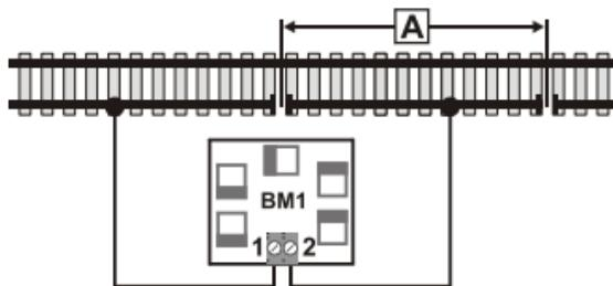
Un interrupteur branché en parallèle aux bornes 1 et 2 vous permettra de mettre en ou hors service le BM1. Pour ce faire, vous pouvez vous servir d'un interrupteur libre du signal. La plupart des signaux disponibles dans le commerce sont équipés d'un moteur à double bobinage et d'un interrupteur au moins.
