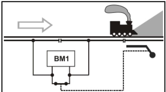
Si l'on désire que le train ne marque pas l'arrêt mais au contraire poursuive sa route, ou encore se remette en marche après l'arrêt, il suffit de ponter les bornes du BM1 à l'aide d'un interrupteur.
