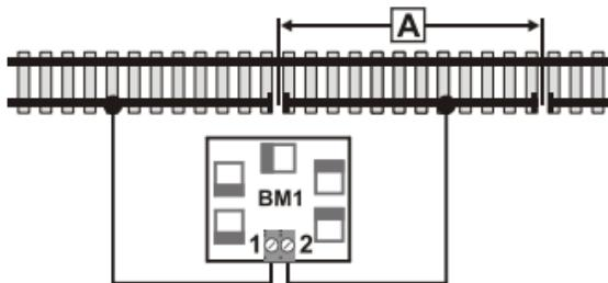
Mit einem Schalter parallel zu den Klemmen 1 und 2 können Sie die Wirkung des BM1 ein- und ausschalten. Sie können hierfür den Schalter eines Signals verwenden. Die meisten handelsüblichen Signale mit Doppelspulen'antrieb sind mit einem solchen Schalter ausgerüstet.
