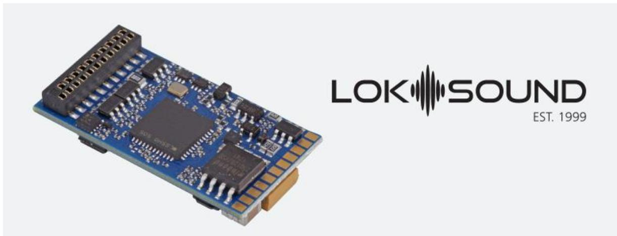
Der LokSound 5 ist das wichtigste Mitglied der LokSound Familie. Durch die Kombination aus Digitaldecoder und Soundmodul auf einer Leiterplatte erreichen wir Abmessungen von nur 30mm x15.5mm und kann somit in nahezu jede Loks der Spurweiten H0 und 0 eingebaut werden.
